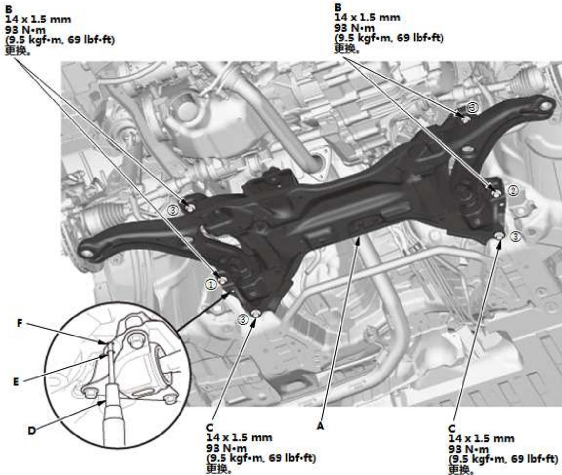
2. 重新安装所有已拆下的零件后，[检查并调整前轮定位](#)。
